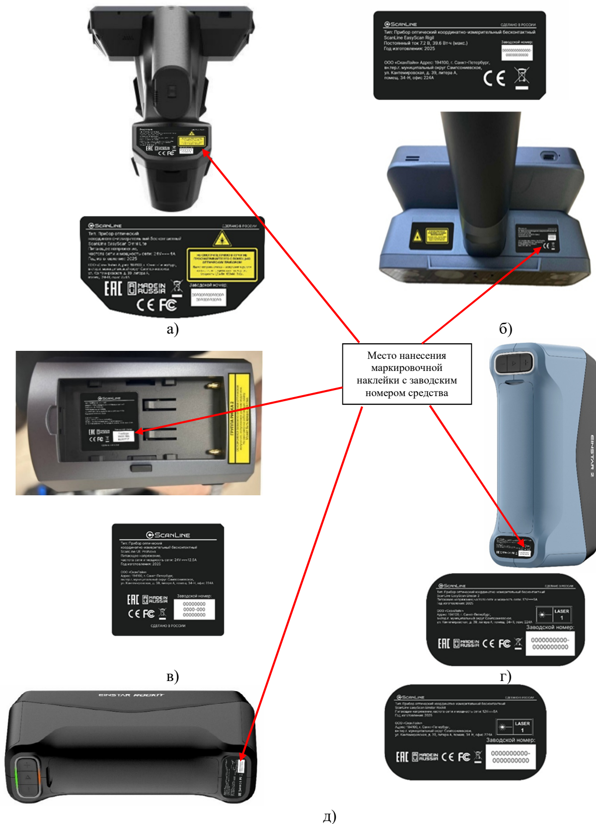
Рисунок 2 – Место расположения маркировочных наклеек с указанием заводского номера приборов оптических координатно-измерительных бесконтактных ScanLine EasyScan модификаций: а) ScanLine EasyScan Omni, ScanLine EasyScan Omni Lite; б) ScanLine EasyScan Rigil, ScanLine EasyScan Rigil Pro в) ScanLine EasyScan UE ProNova, ScanLine EasyScan UE ProNova+, г) ScanLine EasyScan Einstar 2; д) ScanLine EasyScan Einstar Rockit
